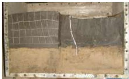
(d) 离心试验后有桩处路堤剖面图
